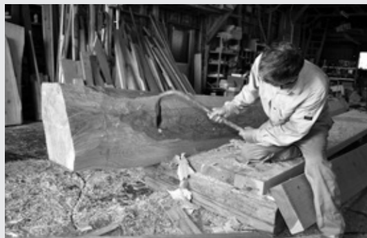
船材の粗木取り 丸太からオモキを削り出す。
