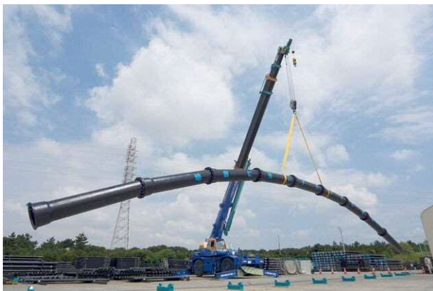
図 6.3.6 耐震継手の柔軟性検証(クボタ)
