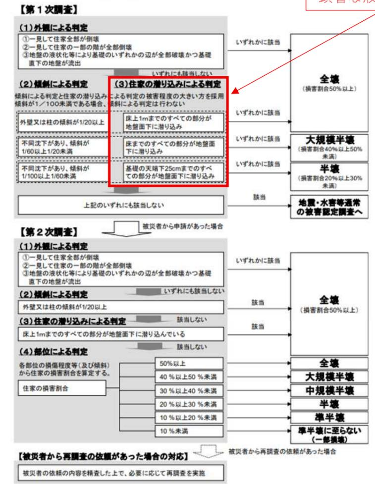
また、内閣府においては、めり込み沈下など液状化等の地盤被害による被害に対して、左図の流れで、被害認定することとしている。
