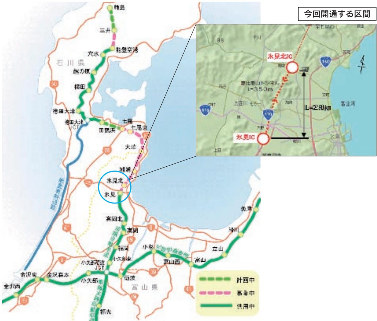
能越自動車道（一般国道470号）は、石川県輪島市から七尾市、氷見市、高岡市などを經由して小矢部砺波ジャンクションまでの総延長約100kmの自動車専用道路です。能越自動車道の整備によって、並行する国道160号の渋滞が解消され、また、災害時などの代替機能もあり、より安心して生活できるようになります。
