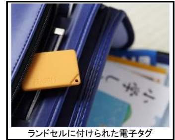
ランドセルに付けられた電子タグ
